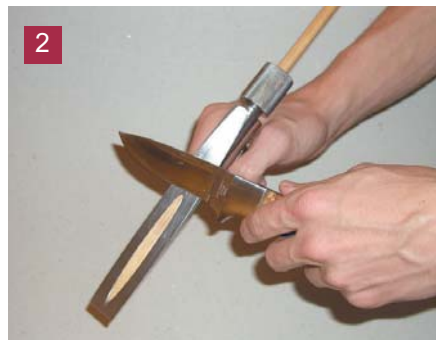
Mit einem Messer wird der Schaft grob vorgeschnitten.
