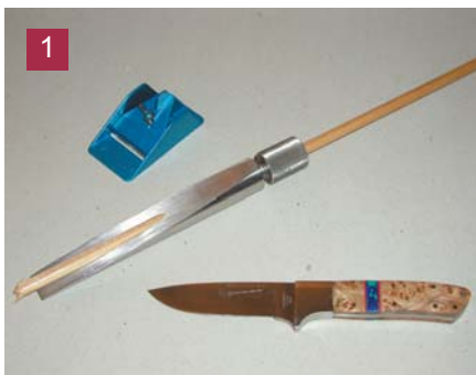
Werkzeug: Spleißrohr, Messer und Hobel.
